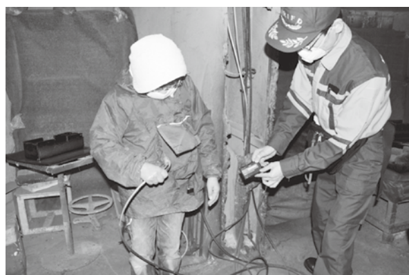
図2 エアブラシでの吹き飛ばし作業の再現と電位測定
