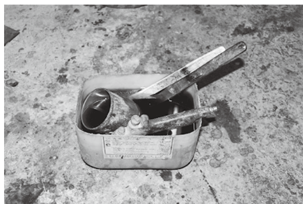
図1 ポリ容器の状況 (アセトン、スプレーノズル、刷毛などが入っている)
