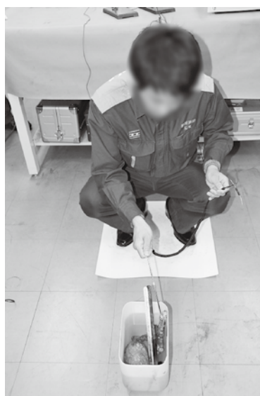
図3 球電極を握りポリ容器内容物へ放電させている状況
